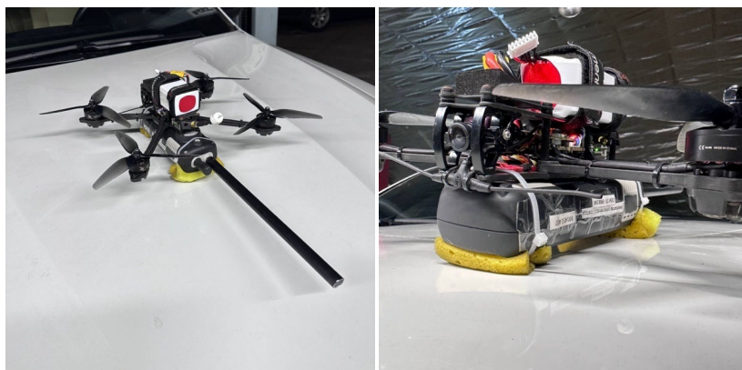
Рис. 4. Модернізований БПЛА із газоаналізатором
